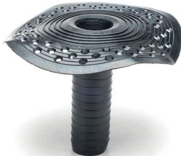
Le **BOCCHETTE SLANG IN EPDM** svolgono la funzione di raccordare i manti impermeabili bituminosi di copertura con gli scarichi pluviali. Il codolo leggermente conico ne agevola la messa in opera nei tubi pluviali.
