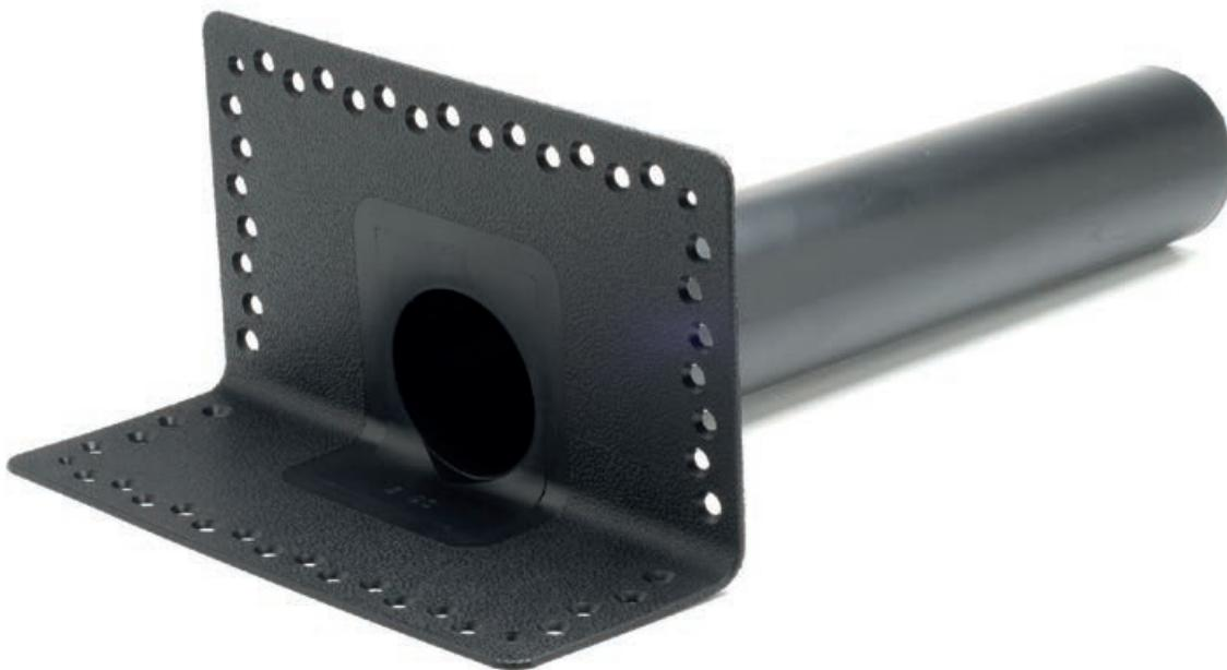
Le **BOCCHETTE SPEIER IN HDPE** hanno la funzione di raccordare i manti impermeabili di copertura con gli scarichi pluviali posti a ridosso di muretti e possono essere posizionate sia in orizzontale che in verticale. I particolari diametri in cui sono prodotte le rendono compatibili con i raccordi angolari dotati di guarnizione a tenuta stagna.
