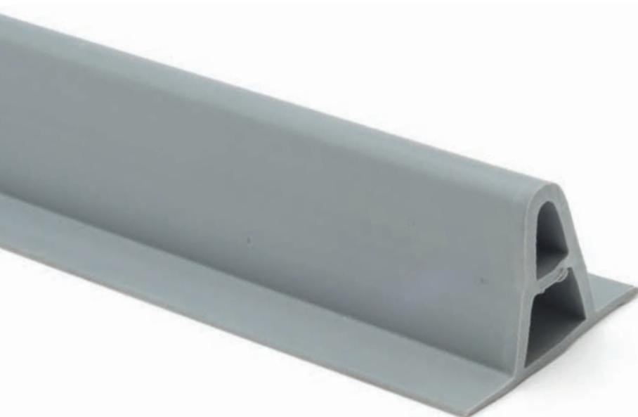
Il **PROFILO ANTARES** è utilizzato come rifinitura nelle coperture impermeabilizzate con teli in TPO e la forma triangolare serve per simulare la tipica nervatura delle lamiere grecate utilizzate nelle coperture degli edifici. Il materiale elastico con cui è prodotto ne garantisce la durata nel tempo.
