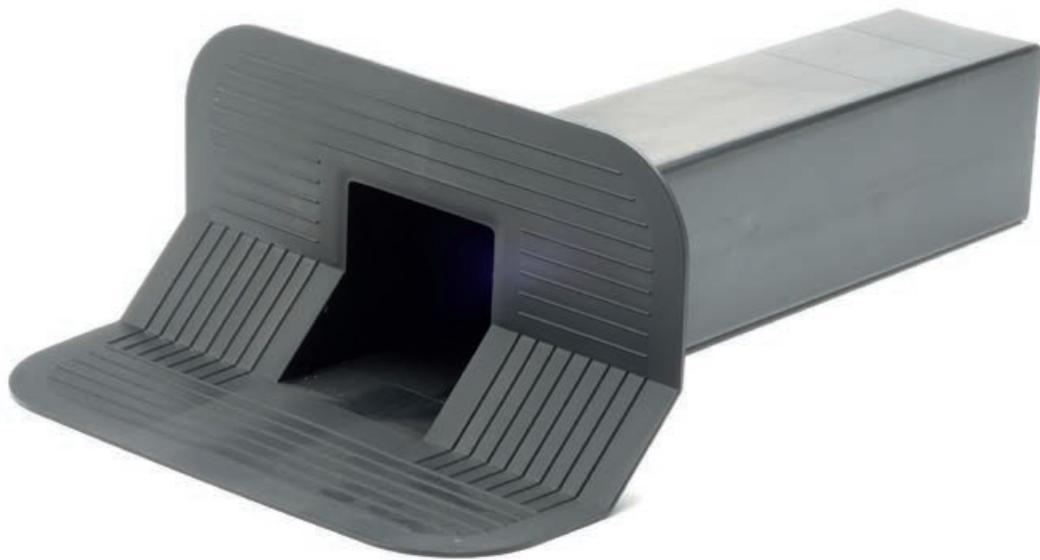
Le **BOCCHETTE ANGOLARI** hanno la funzione di raccordare i manti impermeabili di copertura con gli scarichi pluviali posti a ridosso di muretti e possono essere posizionate sia in orizzontale che in verticale.
