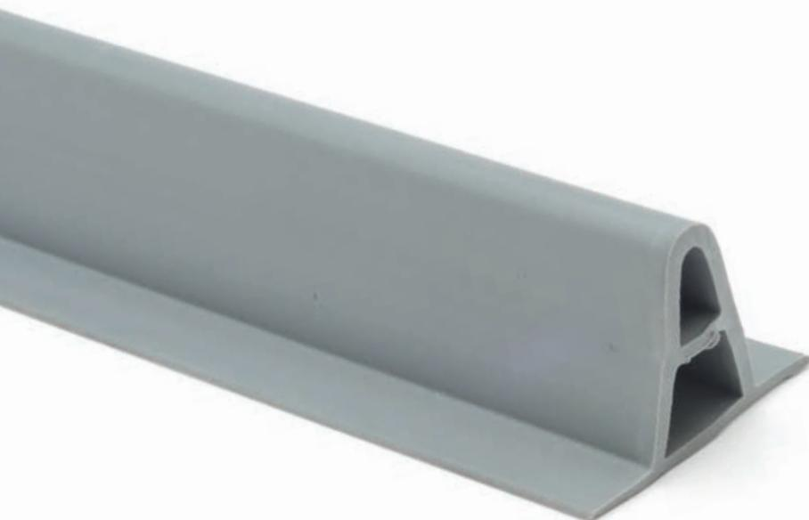
Il **PROFILO ANTARES** è utilizzato come rifinitura nelle coperture impermeabilizzate con teli in PVC e la forma triangolare serve per simulare la tipica nervatura delle lamiere grecate utilizzate nelle coperture degli edifici. Il materiale elastico con cui è prodotto ne garantisce la durata nel tempo.
