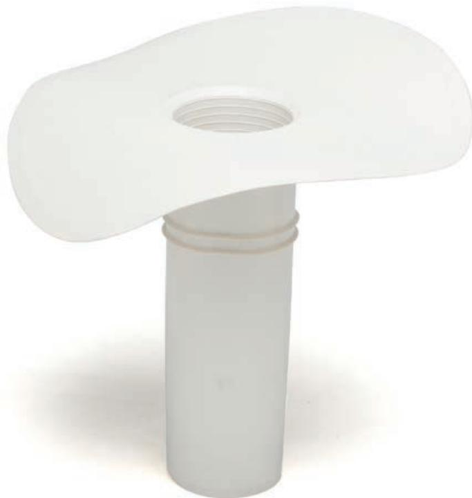
Le **BOCCHETTE ERMETIC IN PVC** svolgono la funzione di raccordare i manti impermeabili sintetici in PVC di copertura con gli scarichi pluviali. Il codolo leggermente conico ne agevola la messa in opera nei tubi pluviali.
