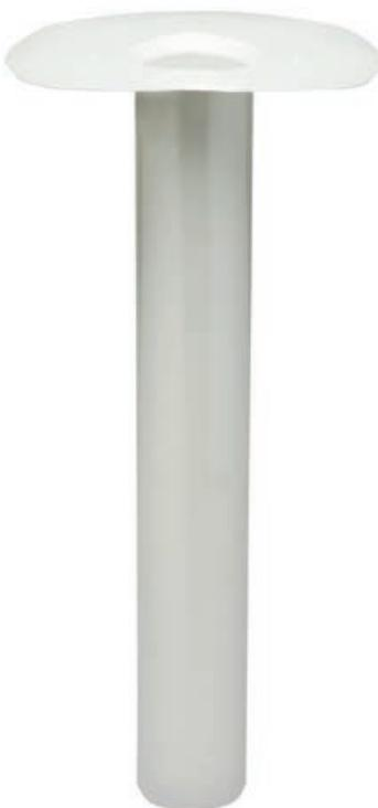
Le **BOCCHETTE INDUSTRIALI IN TPO** svolgono la funzione di raccordare i manti impermeabili sintetici in TPO di copertura con gli scarichi pluviali. Il codolo leggermente conico ne agevola la messa in opera nei tubi pluviali.
