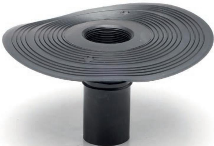
Le **BOCCHETTE ERMETIC IN TPE** svolgono la funzione di raccordare i manti impermeabili bituminosi di copertura con gli scarichi pluviali. Il codolo leggermente conico ne agevola la messa in opera nei tubi pluviali.
