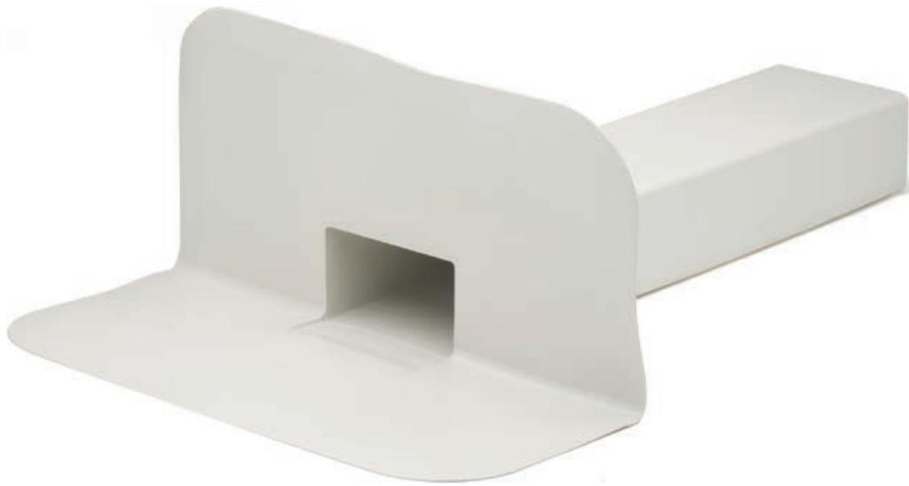
Le **BOCCHETTE ANGOLARI** hanno la funzione di raccordare i manti impermeabili sintetici in TPO di copertura con gli scarichi pluviali posti a ridosso di muretti e possono essere posizionate sia in orizzontale che in verticale.
