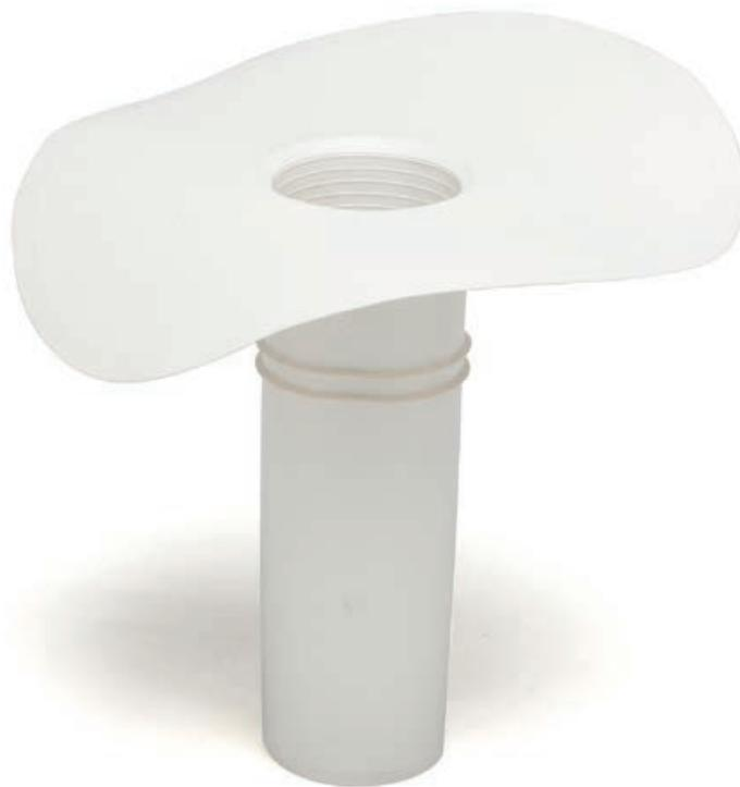
Le **BOCCHETTE ERMETIC IN TPO** svolgono la funzione di raccordare i manti impermeabili sintetici in TPO di copertura con gli scarichi pluviali. Il codolo leggermente conico ne agevola la messa in opera nei tubi pluviali.
