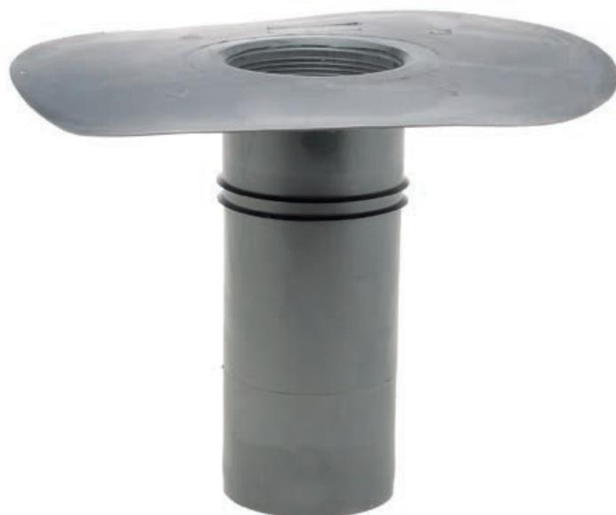
Le **BOCCHETTE ERMETIC IN ECB** svolgono la funzione di raccordare i manti impermeabili sintetici in ECB di copertura con gli scarichi pluviali. Il codolo leggermente conico ne agevola la messa in opera nei tubi pluviali.
