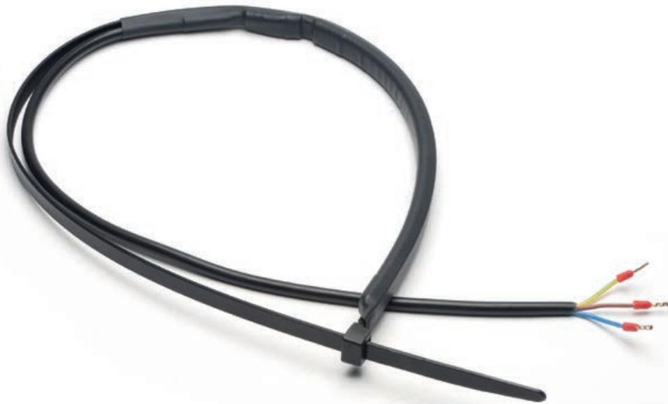
Il **RISCALDATORE FLESSIBILE** è una resistenza elettrica lunga circa 220 mm e larga 15 mm. È assemblato tramite termorestringente nero con una fascetta stringi tubo in nylon 750x7,5 mm. È dotato di un cavo elettrico lungo circa 400 mm.
