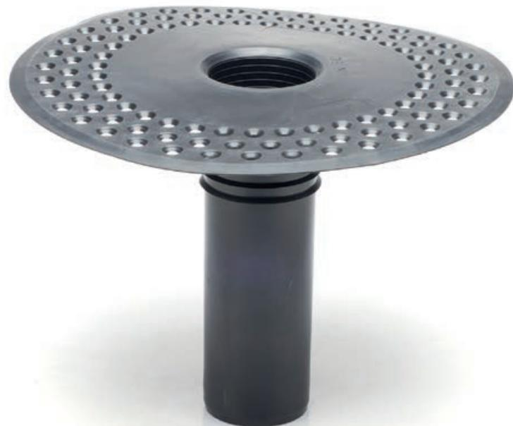
Le **BOCCHETTE ERMETIC IN TPE** svolgono la funzione di raccordare i manti impermeabili bituminosi di copertura con gli scarichi pluviali. Il codolo leggermente conico ne agevola la messa in opera nei tubi pluviali.
