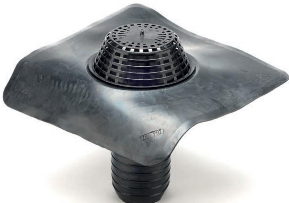
Le **BOCCHETTE SIFONATE IN EPDM** svolgono la funzione di raccordare i manti impermeabili in EPDM di copertura con gli scarichi pluviali evitando, grazie all'apposito sifone, la risalita dei cattivi odori dagli scarichi.
