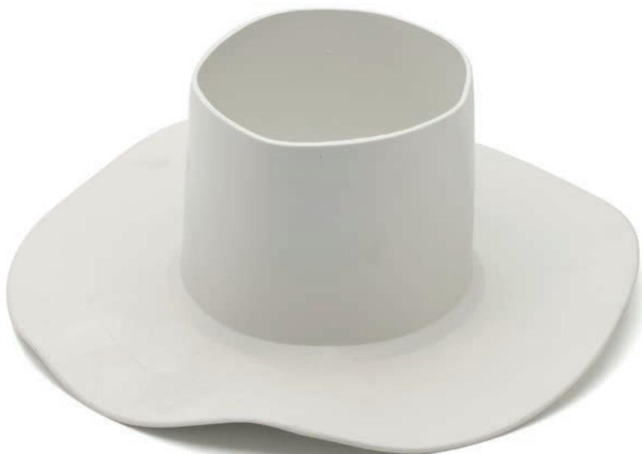
I **COLLARINI IN PVC** svolgono la funzione di raccordare i manti impermeabili sintetici in PVC con eventuali tubi passanti o impianti presenti in copertura. Il codolo leggermente conico ne agevola la messa in opera nei tubi passanti e la flangia completamente liscia favorisce l'incollaggio con i manti in PVC.
