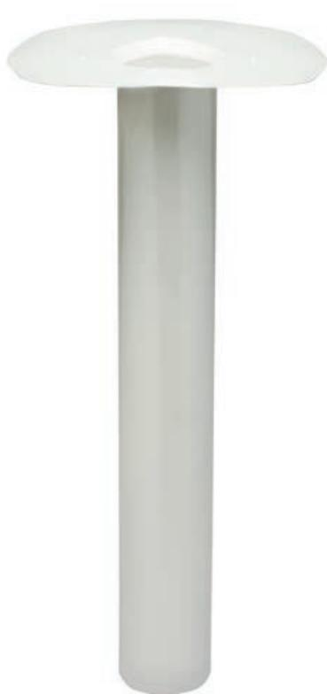
Le **BOCCHETTE INDUSTRIALI IN PVC** svolgono la funzione di raccordare i manti impermeabili sintetici in PVC di copertura con gli scarichi pluviali. Il codolo leggermente conico ne agevola la messa in opera nei tubi pluviali.
