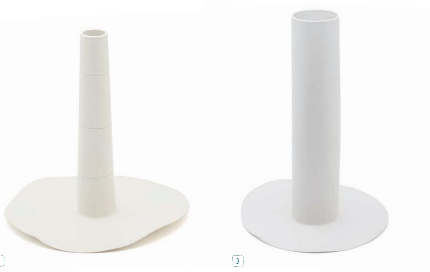
I **COLLARINI IN PVC** hanno la funzione di raccordare i manti sintetici in PVC con eventuali tubi passanti. Sono dotati di un'ampia flangia liscia per un ottimale incollaggio con i manti sintetici in PVC.
