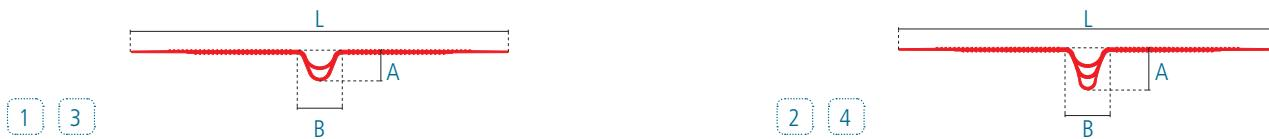
Il bulbo del tipo GDL è dotato di due alette di protezione mentre il tipo GDO dispone di ben tre alette, garantendo così una protezione ancora maggiore.
