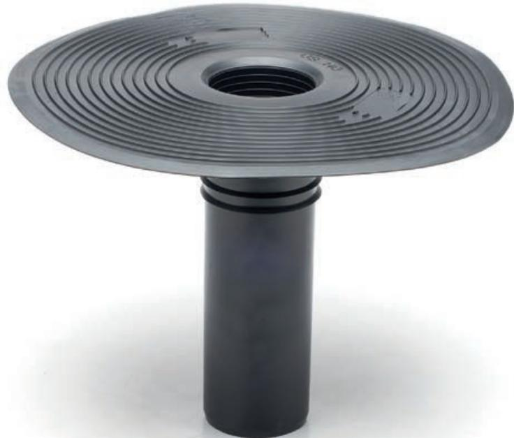
Le **BOCCHETTE ERMETIC IN TPE** svolgono la funzione di raccordare i manti impermeabili bituminosi di copertura con gli scarichi pluviali. Il codolo leggermente conico ne agevola la messa in opera nei tubi pluviali.
