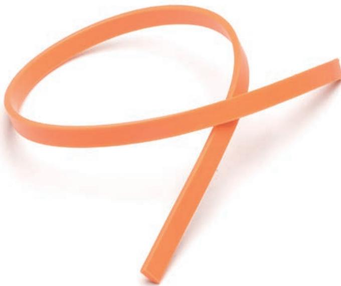
La PIATTINA IN TPO è utilizzata per bloccare il telo in TPO dell'impermeabilizzazione delle piscine al profilo in alluminio lungo il perimetro della piscina. Ha un'ottima resistenza alle degradazioni causate dal sole, dall'ozone e dagli altri agenti atmosferici o chimici normalmente presenti.
