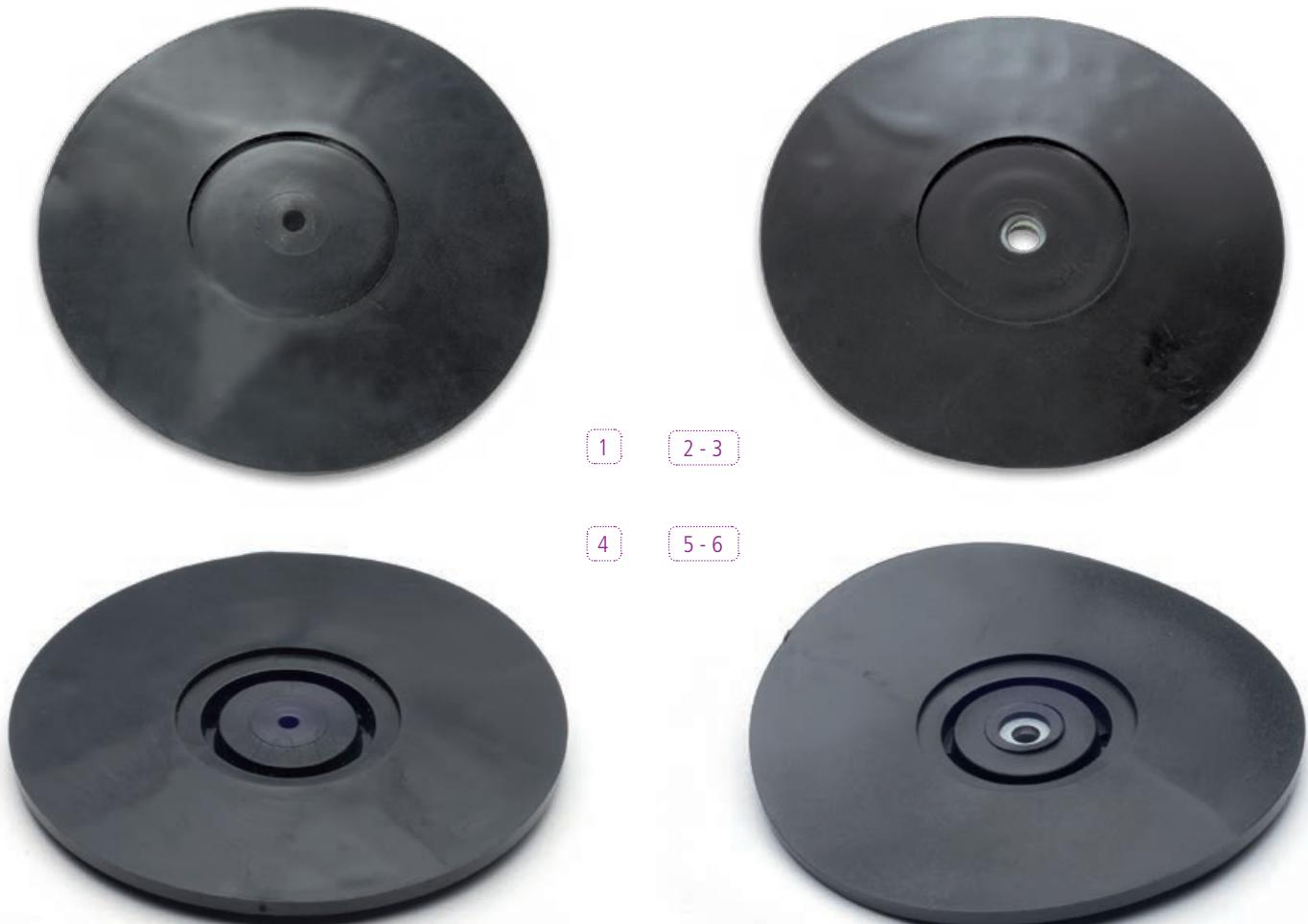
I DISCHI PER GALLERIA hanno la funzione di fissare lo strato diffusore in tessuto non tessuto alla parete della galleria. Fissati i dischi alla parete, si passa alla fase d'incollaggio del telo impermeabile in PVC sui dischi stessi con l'utilizzo di appositi apparecchi a soffio d'aria calda.
