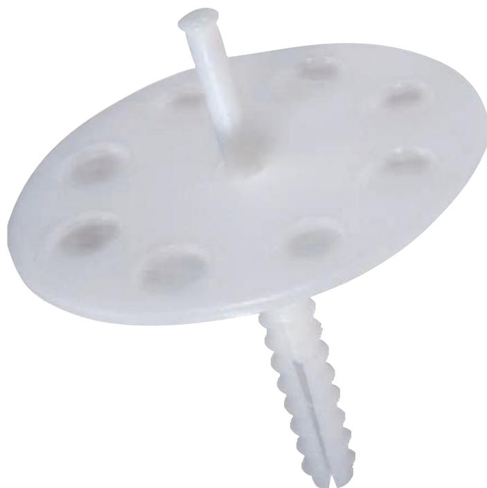
I TASSELLI AD ESPANSIONE TIPO "FGS-TL" sono utilizzati per il fissaggio di pannelli isolanti su supporti tipo calcestruzzo e mattoni forati.
