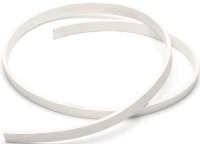
La PIATTINA IN PVC è utilizzata per bloccare il telo in PVC dell'impermeabilizzazione delle piscine al profilo in alluminio lungo il perimetro della piscina. Ha un'ottima resistenza alle degradazioni causate dal sole, dall'ozone e dagli altri agenti atmosferici o chimici normalmente presenti.
