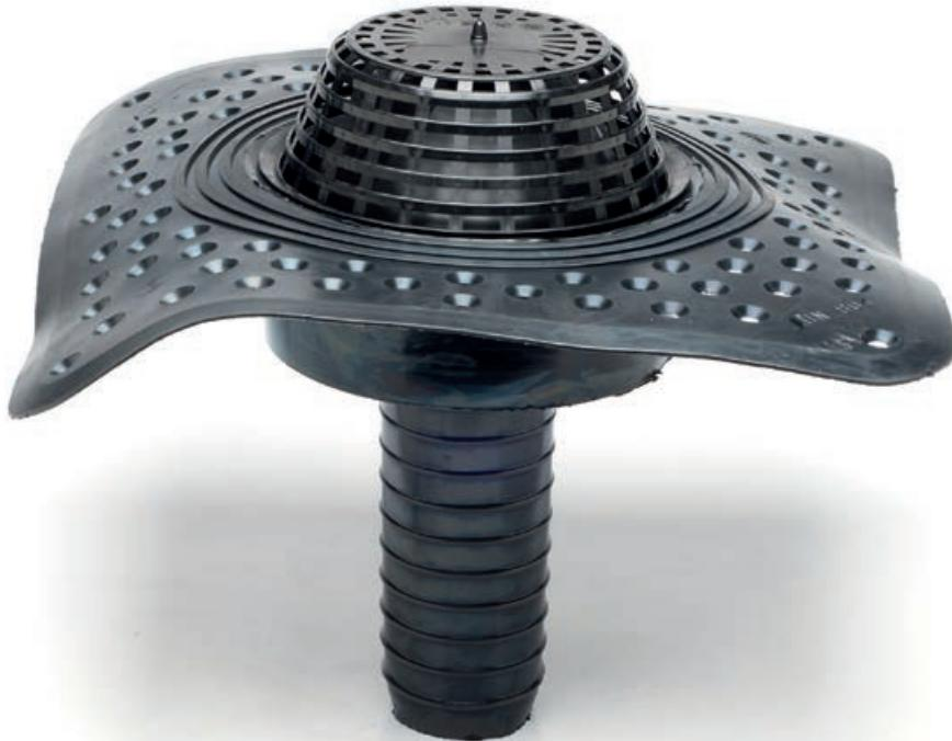
Le **BOCCHETTE SIFONATE IN EPDM** svolgono la funzione di raccordare i manti impermeabili bituminosi di copertura con gli scarichi pluviali evitando, grazie all'apposito sifone, la risalita dei cattivi odori dagli scarichi.
