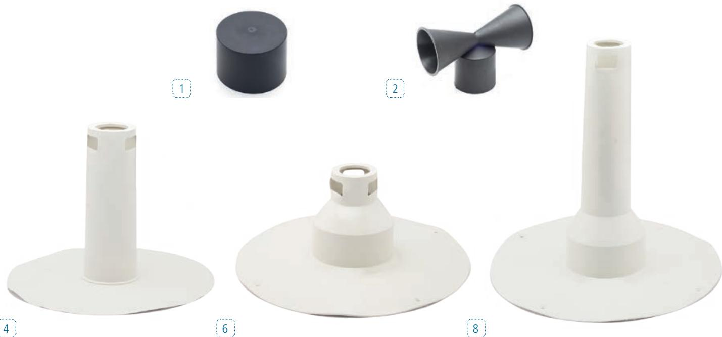
Gli **AERATORI IDEAL IN PVC** sono progettati per favorire l'estrazione dinamica del vapore acqueo che si forma tra la soletta e il manto impermeabile di copertura. Per ottenere il massimo risultato si consiglia la posa di 3-4 aeratori ogni 100 mq. Possono essere utilizzati anche come caminetti d'aerazione per ambienti, soprattutto se abbinati al coperchio Estraer.
