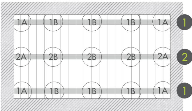
Exemple de schéma de pose pour terrasse rectangulaire fermée sur les quatre côtés. La lettre spécifique indique le type du support dont la pose sera expliquée plus loin en détail.
