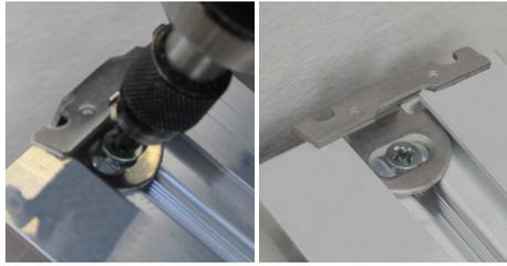
18. Fixer la cale sur la traverse au moyen d'une visseuse adéquate.
