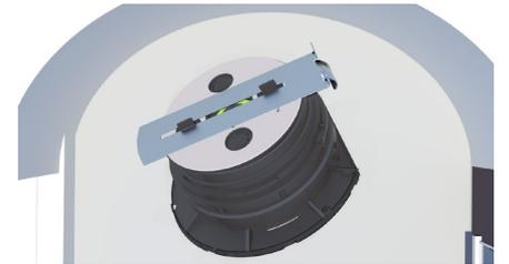
3. Placer la cale SUPACLPP perpendiculairement au mur.
