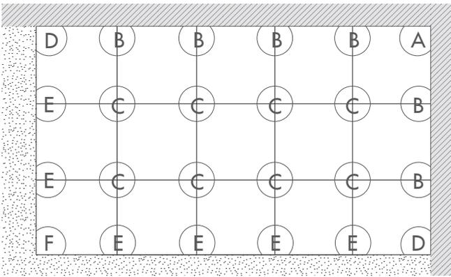
Esquema de colocación para terraza rectangular, abierta por dos lados y cerrada por paredes por los otros dos. El documento especificado indica el tipo de soporte cuya colocación se explicará con detalle a continuación. La instalación debe estar cerrada por todos los lados por paredes o por sistemas específicos de cierre perimetral (clip o perfiles).
