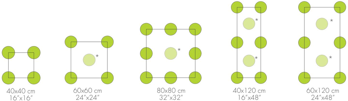
**EJEMPLOS DE ESQUEMAS DE COLOCACIÓN CON VIGAS**
