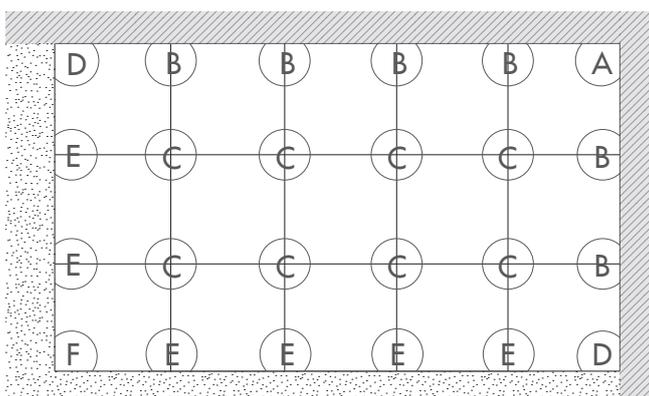
Exemple de configuration d'installation de plots pour une terrasse rectangulaire ouverte sur deux côtés et fermée par deux parois. La lettre spécifiée indique le type de support dont l'installation sera expliquée en détail ci-dessous. L'installation doit être **fermée** sur tous les côtés avec des parois ou avec des systèmes spéciaux de fermeture périmétrale (clips ou profilés).
