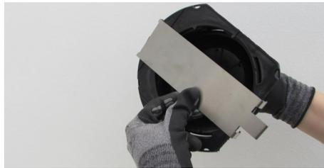
20. Coloque bajo la base del soporte el clip SUPACLPB.
