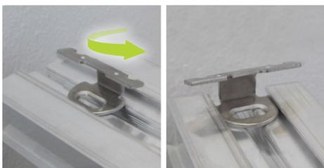
17. Colocar el primer clip SUPCLIP en contacto con la pared. (introducir el clip horizontalmente y a continuación girarlo 90° para asegurar su encaje).
