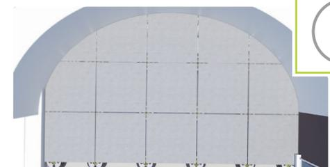
15. Cortar las baldosas de la pared correctamente y colocarlas siguiendo el esquema de colocación.
