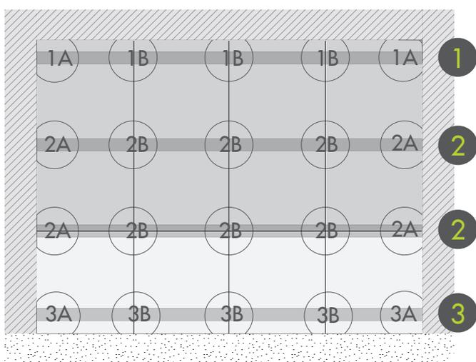
Exemple avec des carrelages de 50x50 cm - 20"x20". Pour des carrelages de dimension supérieure, il est conseillé d'ajouter un support central.
