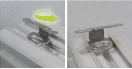
17. Placer la première cale SUPCLIP au contact du mur. (Insérer la cale horizontalement, puis la faire tourner de 90° pour en garantir l'insertion).
