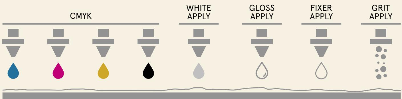
**IT** Un sistema tecnologico digitale di nuova generazione a 8 barre permette alle linee produttive Ricchetti di aggiungere applicazioni materiche e rilievi tridimensionali (T2D) sincronizzati con la decorazione in alta definizione (CMYK) che viene esaltata e valorizzata dal bianco coprente (E4W). Il processo si completa con la tecnologia G+S che definisce gli effetti di finitura della superficie.
